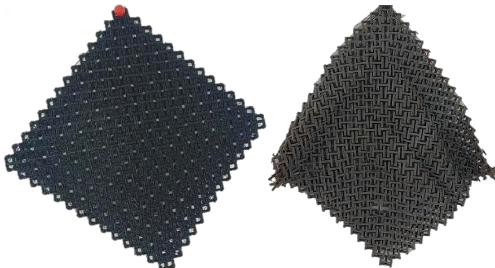
Figura 15: A) Amostra impressa em PLA flexível; B) Amostra impressa em PLA rígido
