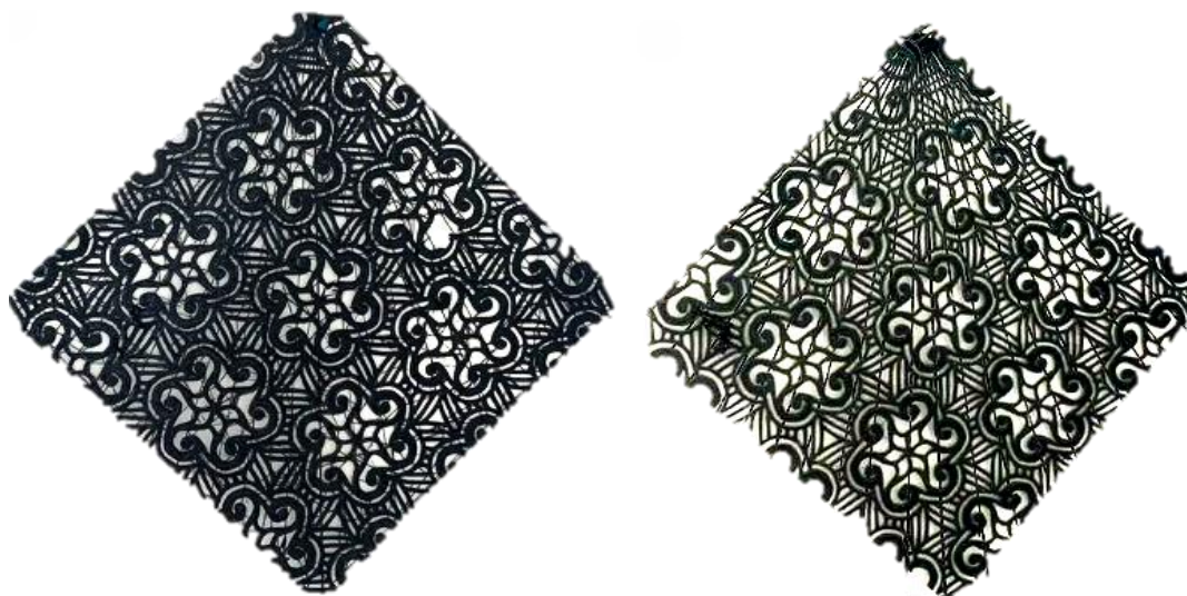
Figura 18: A) Amostra impressa em PLA flexível; B) Amostra impressa em PLA rígido.
