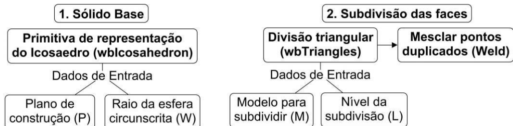
Figura 6: Esquema visual das etapas 1 e 2 da modelagem da Biosfera.
